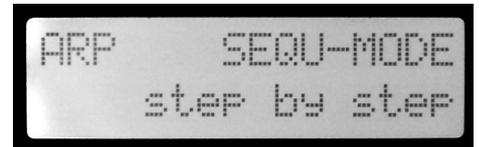
SEQUENCE-MODE bestimmt die Verknüpfung der Arpeggio-Steps mit den Steps der Sequence.
